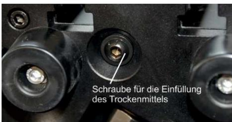
Öffnen Sie diese Schraube an der Gehäuseunterseite mit einem Inbus-Schlüssel der Größe 5, nehmen die Kunststoff-Dichtung heraus und stellen Sie das Gerät hin und lassen das Trockenmittel herausrieseln. Bewegen Sie das Gerät hin und her, damit alle Reste des Granulats vollständig herausrieseln. Sie können das verbrauchte Trockenmittel mit dem Hausmüll entsorgen oder wie weiter unten beschrieben regenerieren und wiederverwenden.
